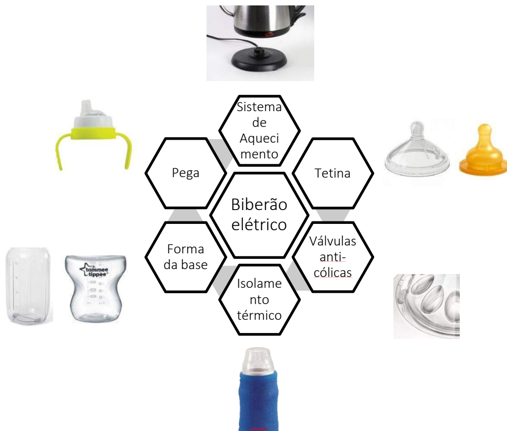
Figura 39: Divisão do biberão elétrico em sub-problemas.
