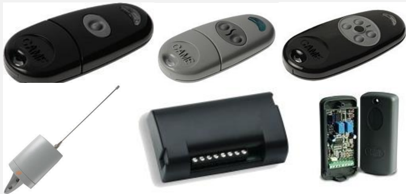
Figura 4 – Alguns comandos e recetores disponíveis no mercado. Caraterizados essencialmente pela radiofrequência de trabalho, nº de canais e de combinações. [13]
