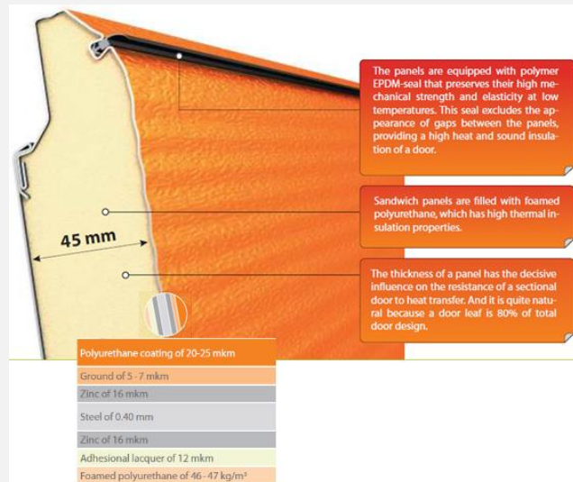
Figura 8 – Composição de um painel em multicamadas (sandwich) num portão seccionado do fabricante JD (UK) Ltd [7]
