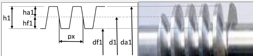
Figura 16 - Nomenclatura de parâmetros geométricos do parafuso sem-fim
