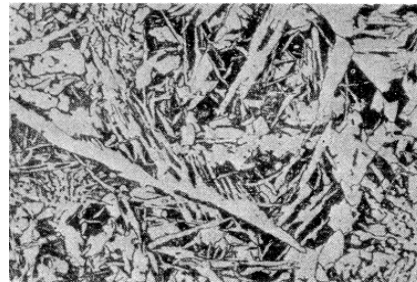
Aço vazado com 0,28%C
