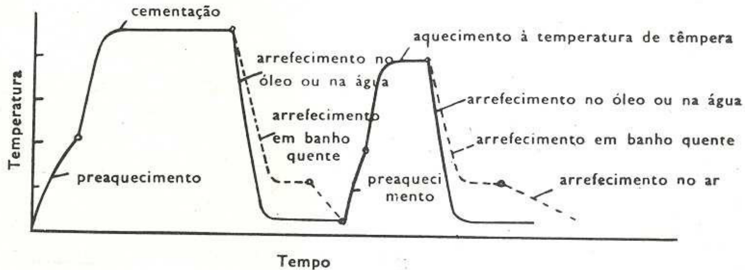
Fig. 75 — Têmpera dupla sendo a 1. a têmpera directa a partir da temperatura de cementação.
