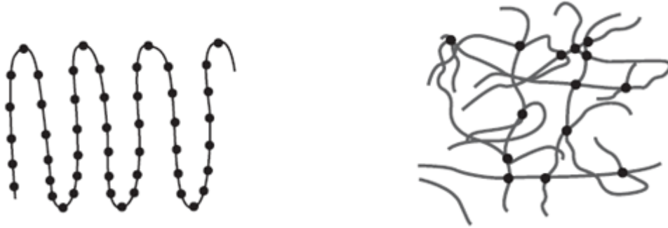
Fig. 9 - Cadeias abertas no polietileno (esq.) e ligações cruzadas aumentam rigidez (dta.) (Wikipédia).
