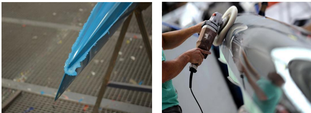
Fig. 29 - Corte de rebarbas no plano de separação (esq.) e polimento final (dta.).
