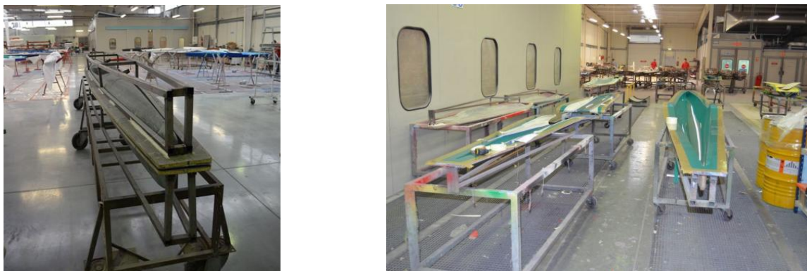
Fig. 23 - Molde fechado (esq.) e aberto (dta.) em fibra de vidro.
