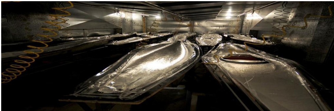
Fig. 27 - Aplicação de vacuo em estufa para cura da resina.
