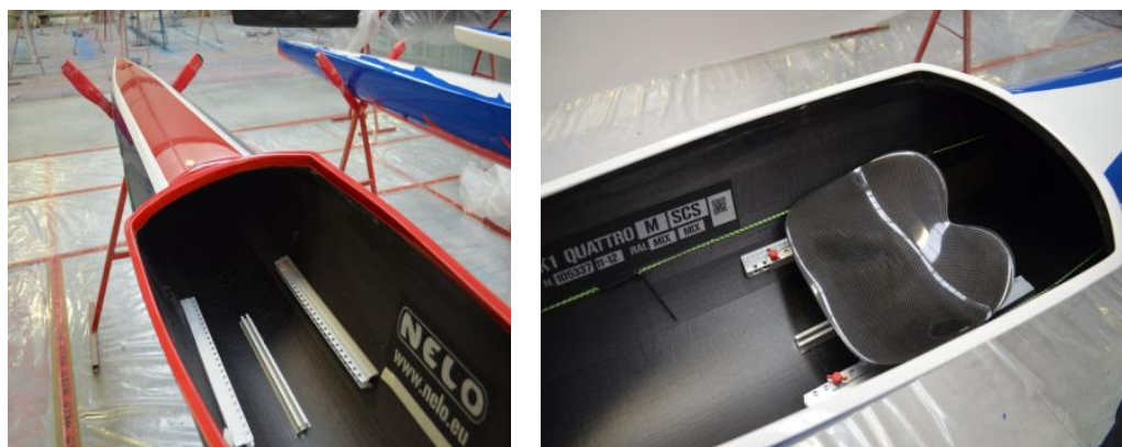
Fig. 30 - Colagem de perfis metálicos (esq.) e colocação do banco (dta.).
