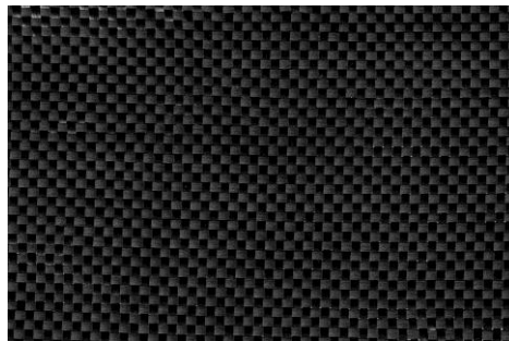
Fig. 15 - Fibras de carbono dispostas perpendicularmente umas às outras (Produtos Alibaba).
