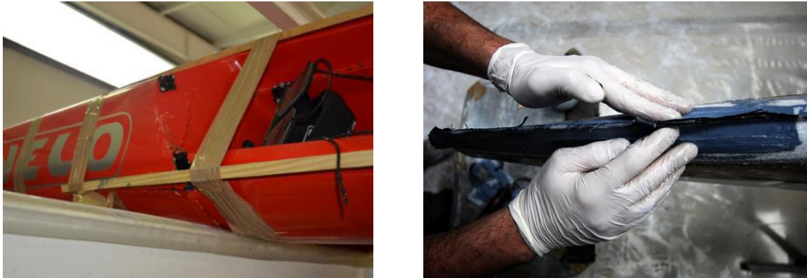
Fig. 31 - Casco danificado (esq.) e reparação na proa (dta.).
