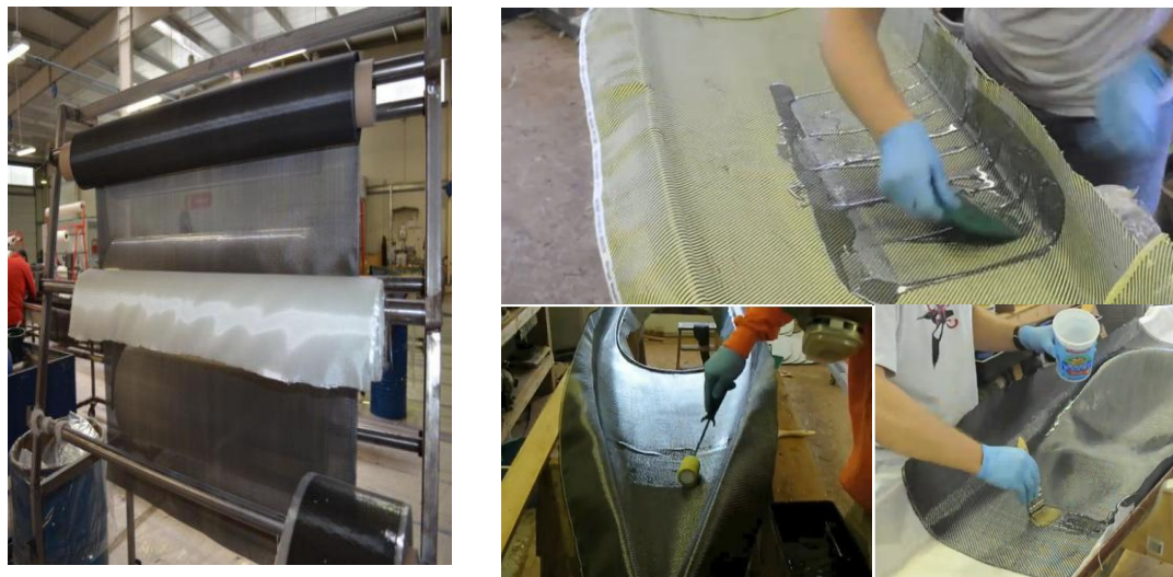
Fig. 25 - Bobines de fibra (esq.) e impregnamento manual (dta.).
