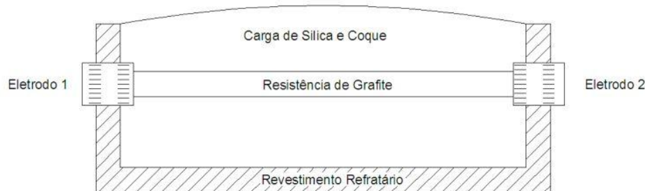
Fig. 18 - Esquema representativo do processo de Acheson. (Grupta et al., 2001)
