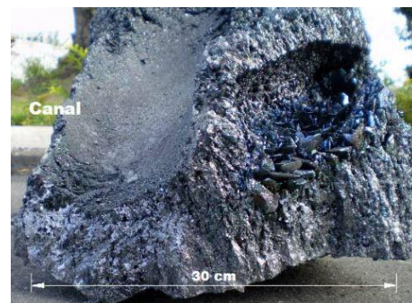
Fig. 20 - Bloco de SiC antes de ir para a moagem
