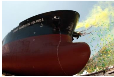
Fig. 50 - Muitos barcos têm esta forma estranha para minimizar o arrasto causado pelas ondas que o barco cria ao "cortar" a água.
