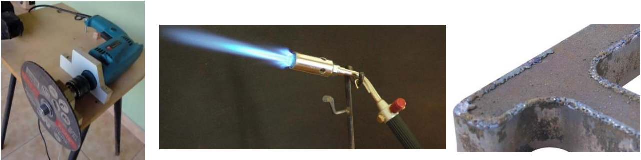
Fig. 8 Disco de esmeril, serra de maçarico e uma peça xeia de rebarbas.
