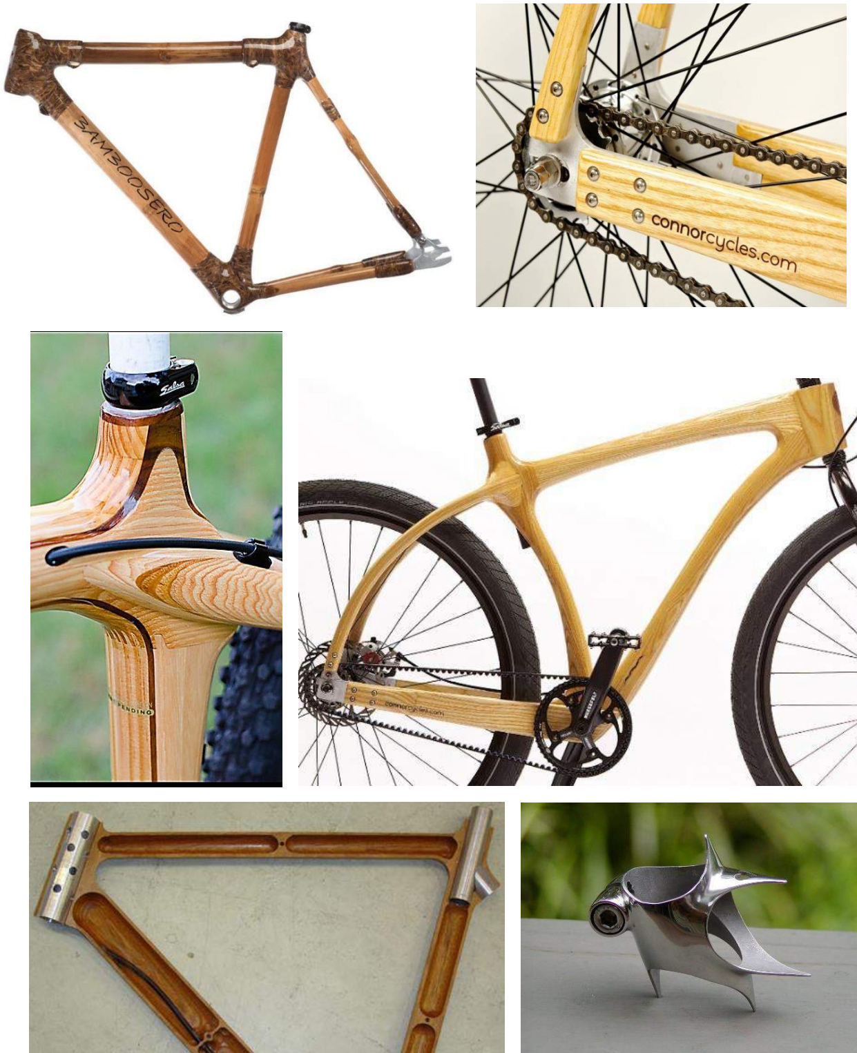
Figura 58 – Alguns dos métodos empregues na ligação de tubos de madeira: Fibras naturais e sintéticas, parafusos, adesivos para juntas em madeira, tubos e juntas metálicas.
