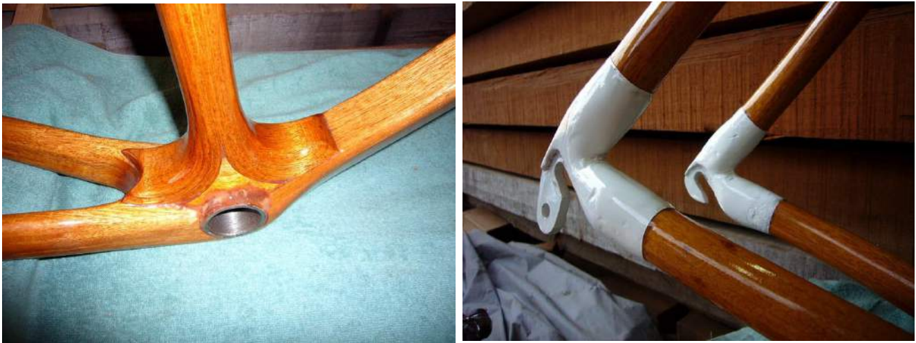
Figura 61: Esq.: Vista de cima do tubo da pedaleira. Dª: Ligação dos dropouts por junta de superalumínio, obtido por fundição. [22]
