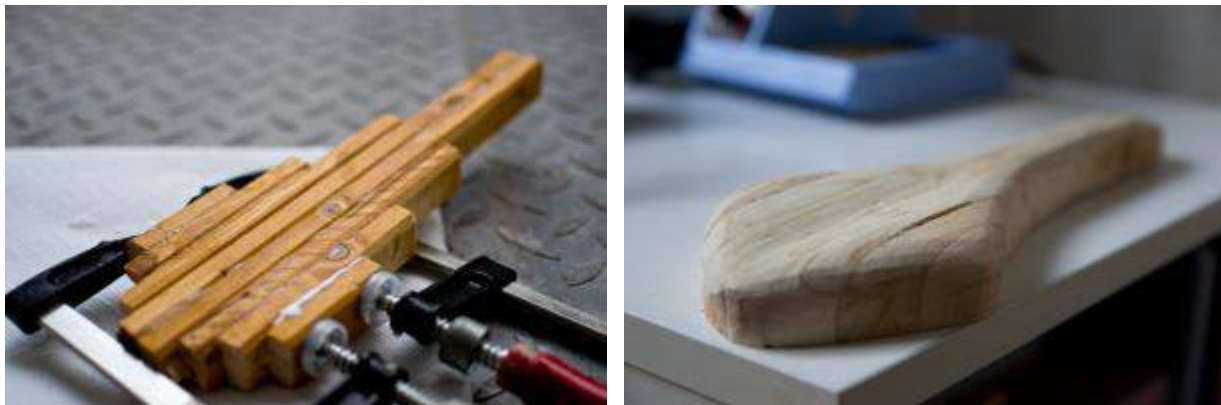
Figura 49: Construção do assento em madeira pelo método de junção de folhas de madeira com resina. [23]
