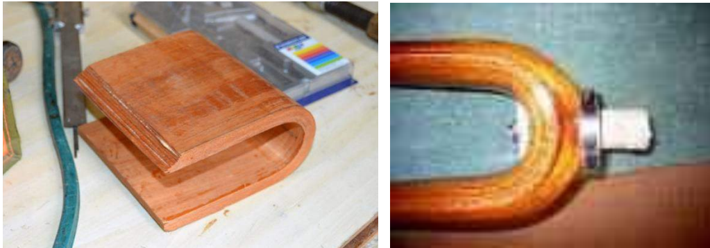
Figura 48: Esq.: Folhas de mogno coladas, antes de serem cortadas com a forma da forqueta. Dª. Forqueta acabada. [22]
