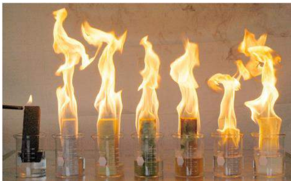
Figura 7.14 – O resultado da mistura do termofluido com o material do isolamento térmico das tubagens. A amostra mais à esquerda refere-se ao vidro celular. As outras amostras são de várias lãs minerais.
