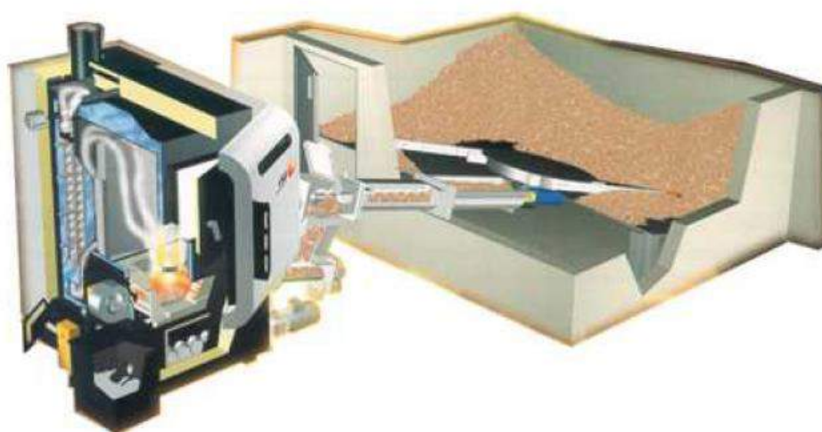
Figura 1.31 – Esquema de uma caldeira doméstica com armazenamento de grande capacidade e alimentação automática de peletes.
