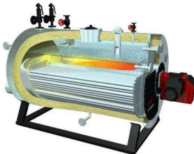
Figura 2.3 – Caldeira de tubos de fumo para a produção de vapor de água.
